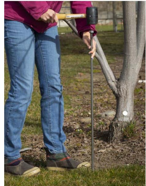
Utilisez l'outil de pose de piquets N° 13429 pour pré-percer des trous pour les piquets QC4 et QC5. Vous garantirez ainsi une installation verticale des piquets.
